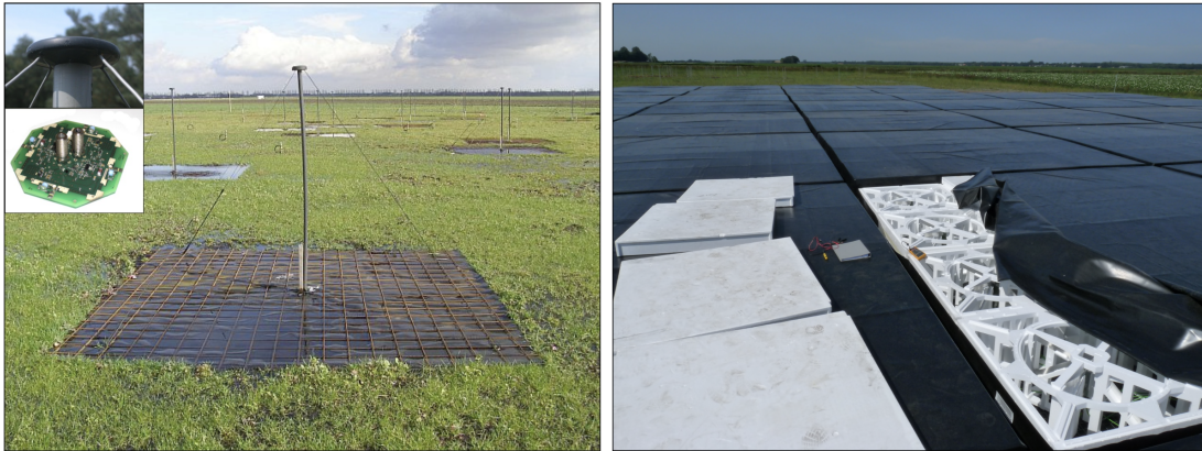
Slika 1.24: LBA (lijevo) i HBA (desno) antene. U gornjem lijevom kutu pored LBA antene prikazano je pojačalo. Pločasti elementi od stiropora unutar HBA stanice, ispod kojih je po 16 antena, međusobno su razmaknute za 15 cm. Preuzeto iz van Haarlem et al. (2013).
