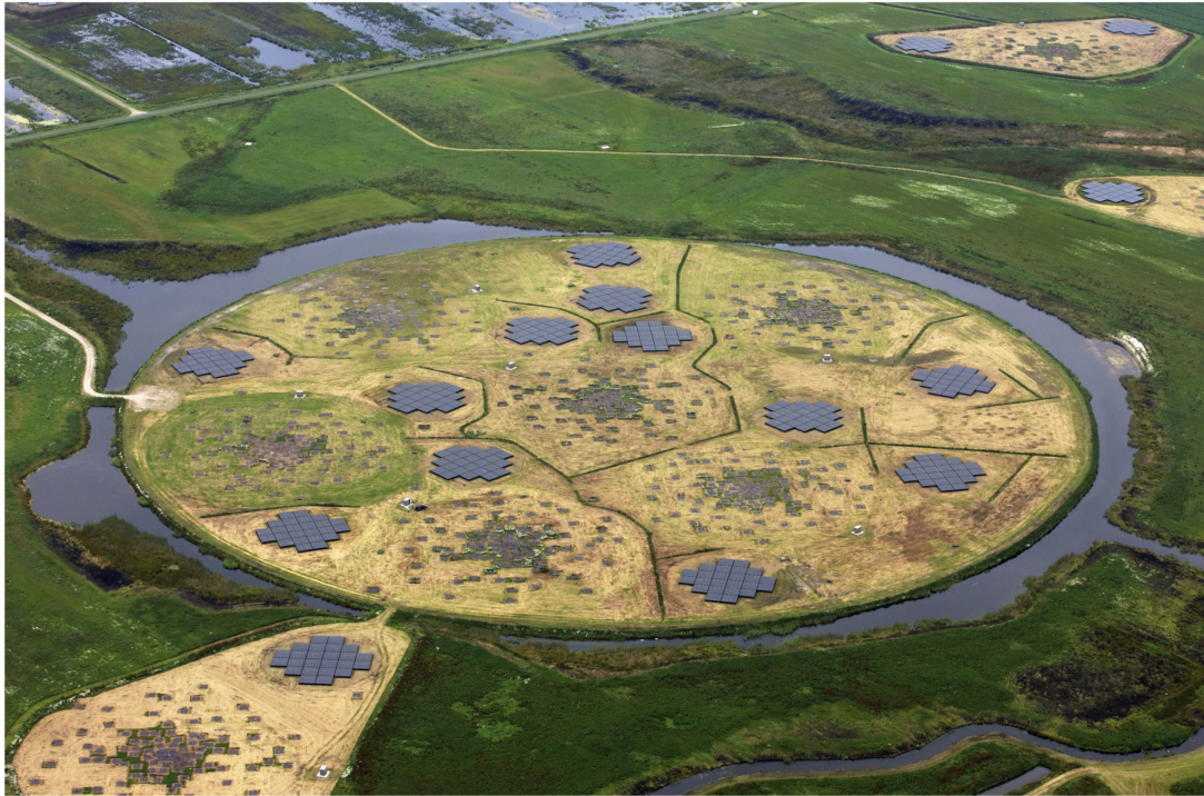
Slika 1.26: Središnji dio radiointerferometra LOFAR (Superterp) u Nizozemskoj. Unutar kruga nalazi se 6 središnjih stanica, a van istoga vide se još 3 središnje stanice. Preuzeto iz van Haarlem et al. (2013).
