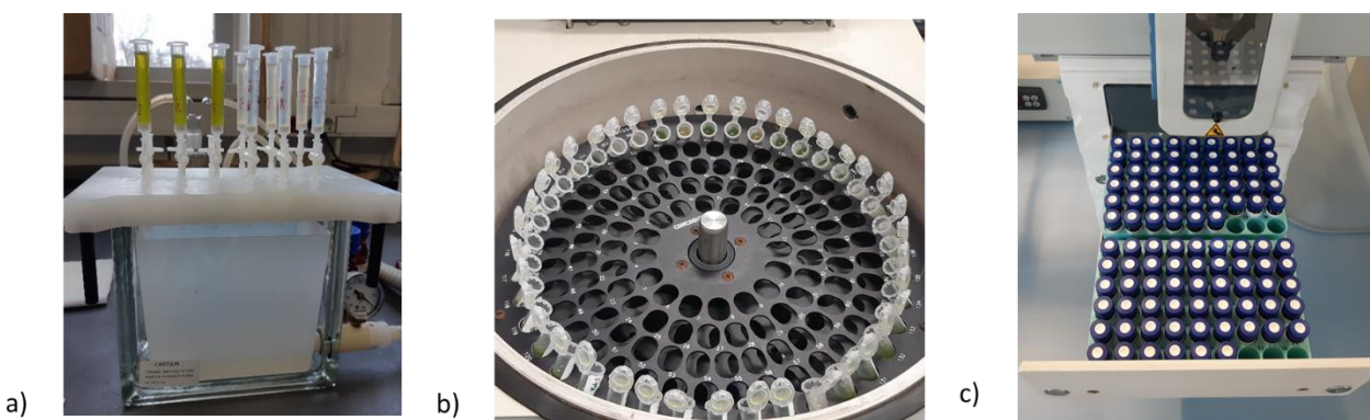
Slika 2. a) Oasis HLB Prime kolone postavljene na vakuumski ekstraktor, b) sušenje supernatanata na uparivaču c) analiza uzoraka masenom spektrometrijom.
