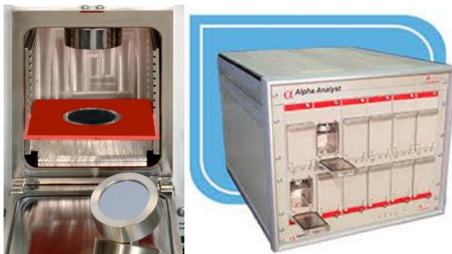
Slika 2.7. Fotografija jedne komore alfa-spektrometra s PIPS-detektorom (lijevo) te jedne jedinice sa setom od 12 komora (desno) (Alpha Analyst™, Canberra)
