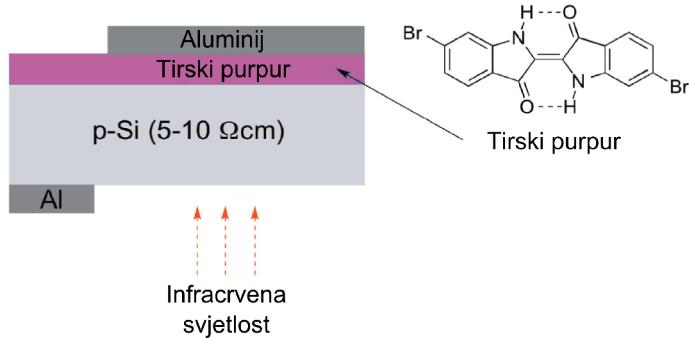
**Slika 7.5:** Shematski prikaz hibridne diode temeljene na heterospoju Al/p-Si/tirski purpur/Al, s prikazanom strukturnom formulom tirskog purpura (6,6'-dibromoindigo).
