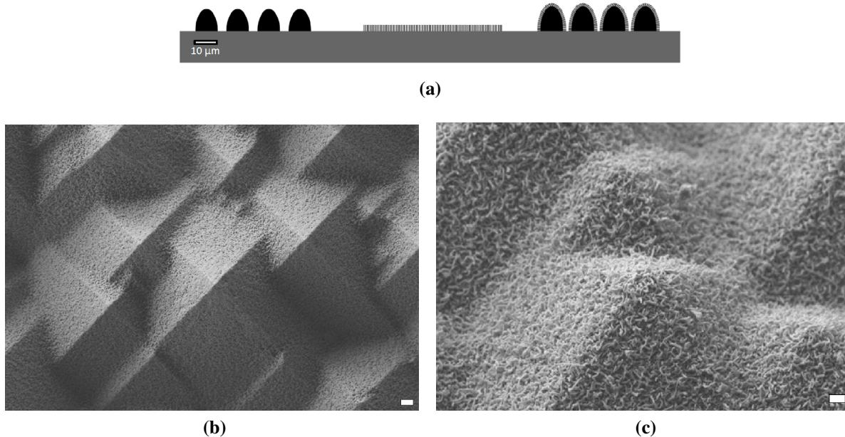
**Slika 2.12:** (a) Ilustracija mikro, nano i hijerarhijskog strukturiranja i primjeri hijerarhijski strukturiranog silicija: SEM mikrografi (b) silicijskih mezoporoznih mikropiramida i (c) silicijskih nanožica na silicijskim mikropiramidama. Veličina skale je  $1 \mu\text{m}$ .
