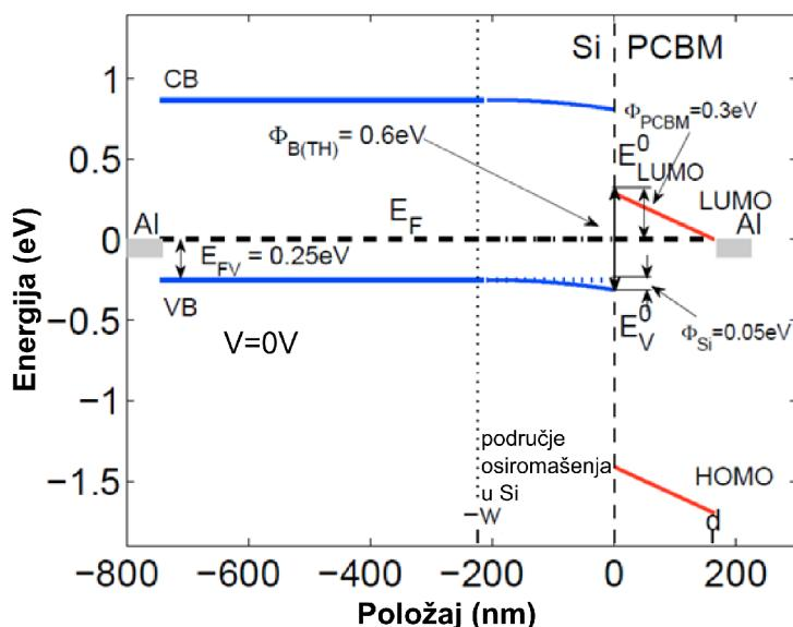
(b) heterospoj *p*-silicija i organskog poluvodiča elektronskog tipa, derivata fullerena PCBM, u diodi u uvjetima kratkog spoja. Slika prilagođena iz [106].
