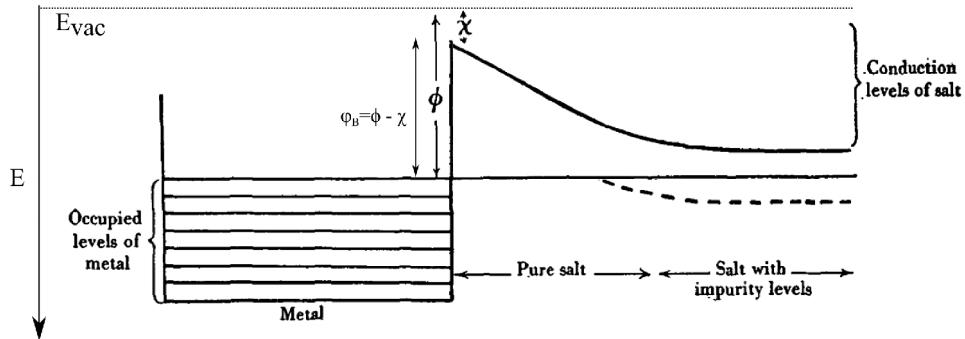
**Slika 6.6:** Ilustracija Schottky-Mott pravila za visinu barijere na kontaktu metala i ionskog kristala soli. Preuzeto i prilagođeno iz N.F.Mott (1938). *Note on the contact between a metal and an insulator or semi-conductor. Mathematical Proceedings of the Cambridge Philosophical Society.* 34, pp 568-572 [125].
