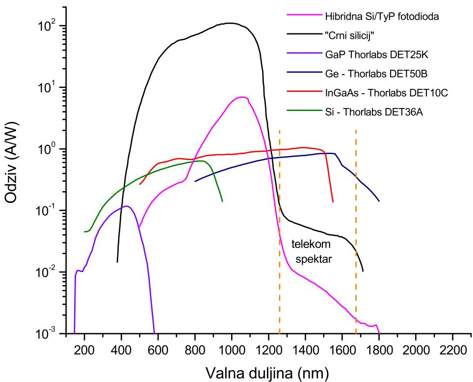
**Slika 7.11:** Usporedba krivulja spektralnog odziva fotodioda korištenih u fotodetektorima s hibridnom silicij/organskim fotodiodom
