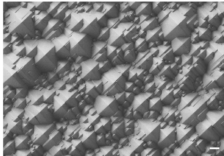
**Slika 2.10:** SEM mikrograf uzorka silicijske pločice  $<100>$  kristalne orientacije strukturiranog anizotropnim jetkanjem u vodenoj otopini KOH i 2-propanola. Duljina skale je  $10\mu\text{m}$ .
