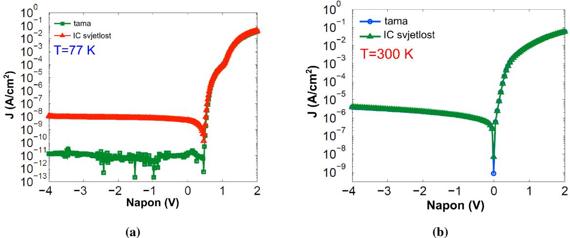
**Slika 7.1:**  $J$ - $V$  karakteristike hibridne heterodiode  $p$ -silicija i iz otopine nanesenog PCBM-a, izmjerene na (a) temperaturi vrelišta tekućeg dušika i (b) sobnoj temperaturi, u tami i obasjana blisko-infracrvenom svjetlošću [106].
