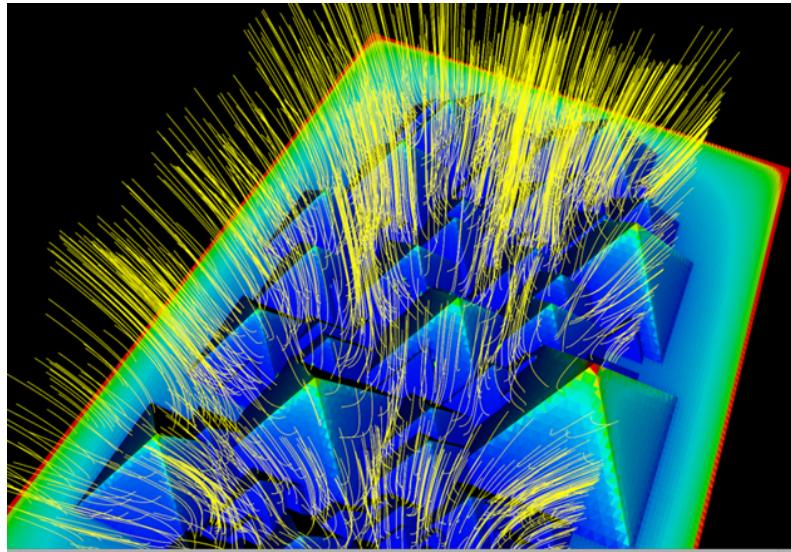
**Slika 7.17:** Prikaz elektrostatskog modela piramidama strukturirane površine. Površina je na zadanim potencijalu  $V_0$ , boja određuje gustoću naboja (rastuća gustoća od plave prema crvenoj boji), žutom linijom su prikazane silnice električnog polja.
