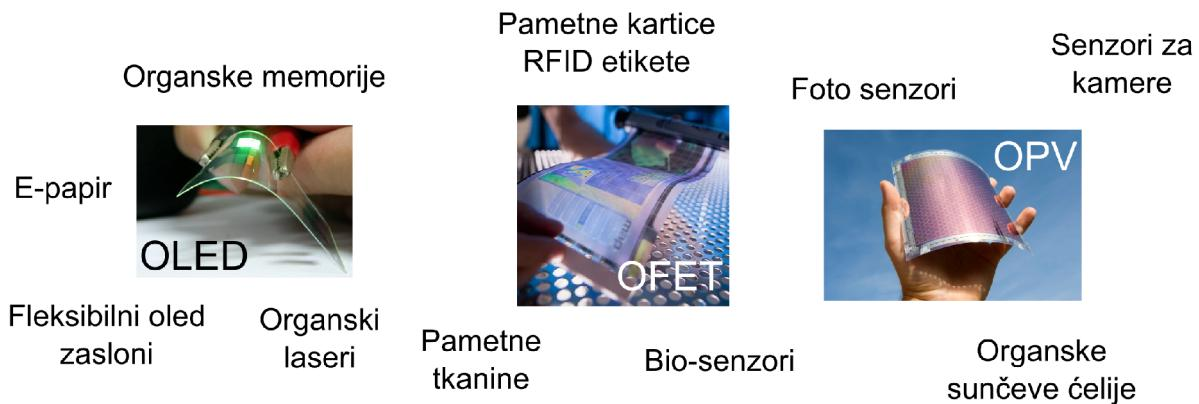
**Slika 3.11:** Neke primjene organskih poluvodiča, temeljene na organskim svjetlećim diodama (OLED), organskim tranzistorima s učinkom polja (OFET) i organskim fotovoltaicima (OPV). Izvor slike: U.S. Army RDECOM, meharris(Wikimedia), [96].
