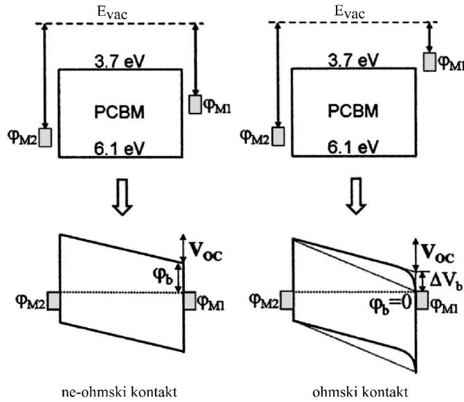
**Slika 4.8:** Ilustracija formiranja ne-ohmskog i ohmskog kontakta na sučelju metal-a i organskog poluvodiča. Ohmski kontakt nastaje ako je radna funkcija metala manja od Fermijeve razine u OPV, što je uvijek ostvareno ako je radna funkcija metala manja od LUMO razine. U suprotnom slučaju formira se Schottky-eva barijera na sučelju.
