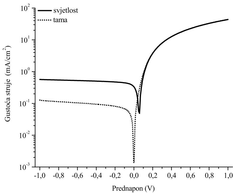
**Slika 6.3:** J-V karakteristika hibridne diode p-Si/tirske purpur u mraku i pri osvjetljenju infracrvenom svjetlošću.
