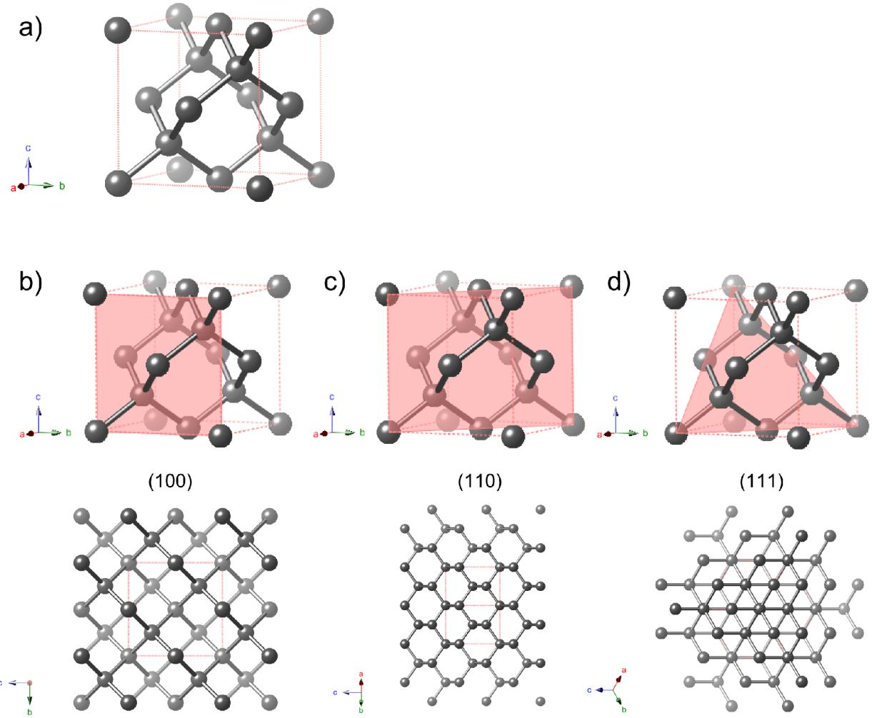
**Slika 3.1:** a) Jedinična čelija dijamantne kristalne strukture silicija i prikaz kristalnih ravnina i orientacija: b) (100) c) (110) i d) (111). Slika prenesena iz [68]
