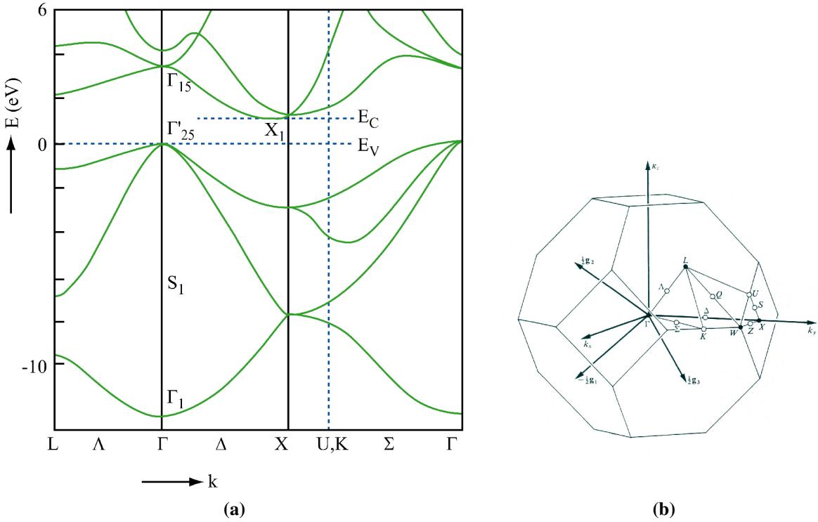
**Slika 3.2:** (a) Struktura elektronskih vrpcia kristalnog silicija. Izvor: MIT OpenCourseWare i (b) prikaz Brillouinove zone plošno centrirane kubične rešetke s označenim točkama visoke simetrije [49, 68]
