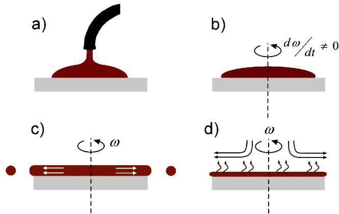
(a) nanošenje materijala **b)** akceleracija podloge **c)** vrtnja konstantnom kutnom brzinom i stanjivanje **d)** vrtnja konstantnom brzinom i isparavanje otapala
