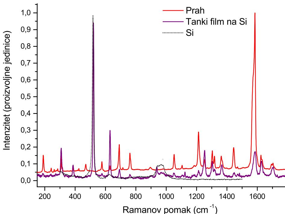
**Slika 6.9:** Usporedba ramanskih spektara tirskog purpura u obliku praha i u obliku tankoga filma na siliciju. Različiti omjeri intenziteta vrpcu mogu biti indikator interakcije tirskog purpura sa površinom silicija.
