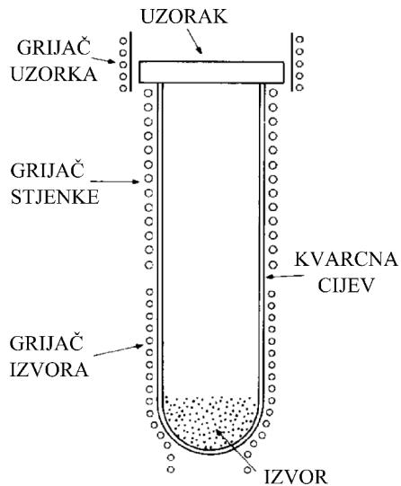
**Slika 4.6:** Pojednostavljeni prikaz reaktora za epitaksijalnu depoziciju u reaktoru s vrućim stijenkama. Cijeli reaktor se nalazi u vakuumskoj komori. Izvor, stjenke i podloga se mogu neovisno grijati. Slika prilagođena iz [116].
