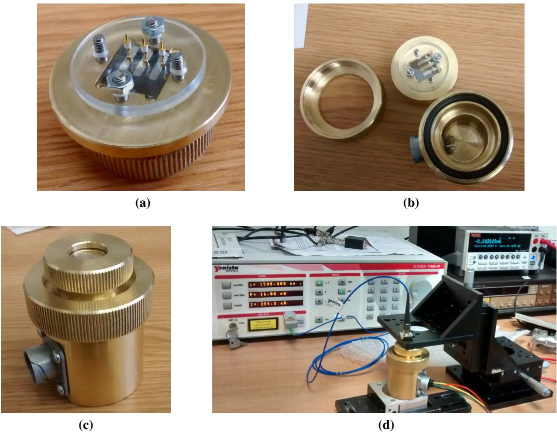
**Slika 5.2:** (a)-(c) hermetički izolirana ćelija za električna mjerena, (d) mjerni postav za mjerene podesivim laserom.
