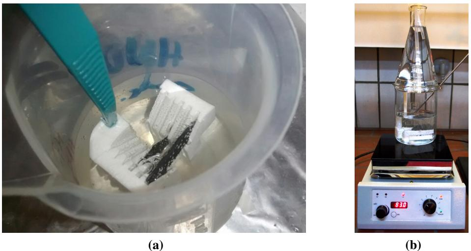
**Slika 4.2:** (a) Bezstrujno jetkanje uzoraka silicija u otopini  $V_2O_5$  u fluorovodičnoj kiselini i (b) anizotropno jetkanje  $<100>$  orijentiranog silicija u otopini KOH i 2-propanola.
