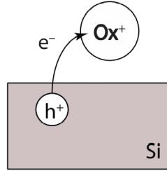
**Slika 2.6:** Shematski prikaz procesa injektiranja šupljine u silicij oksidantom. Elektron iz silicija biva predan oksidantu u otopini, što rezultira pojavom šupljine u valentnoj vrpci silicija [57].
