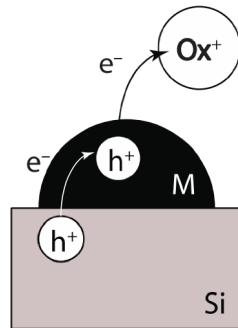
**Slika 2.8:** Shematski prikaz metalom potpomognutim procesom injektiranja šupljine u silicij oksidantom . Elektron iz silicija biva predan metalu na površini te oksidantu u otopini, što rezultira šupljinom u valentnoj vrpci silicija [57].
