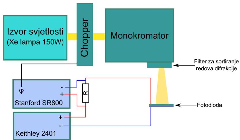
**Slika 5.4:** Shematski prikaz sustava za mjerene spektralnog odziva fotodioda PTS-2-QE.
