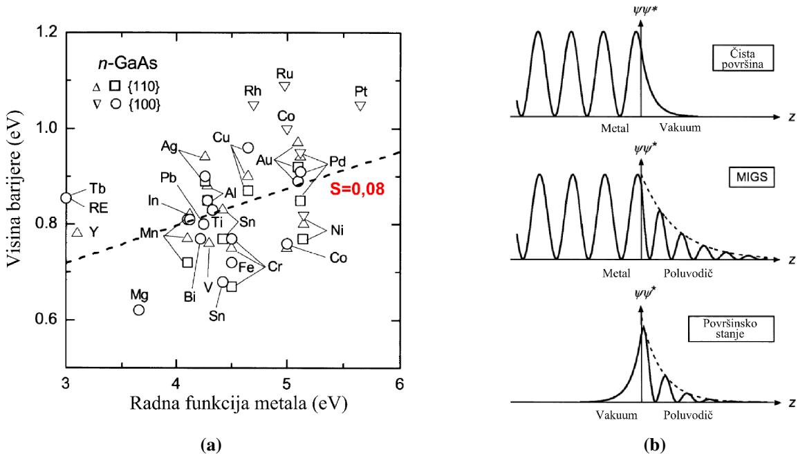
**Slika 6.7:** (a) Ovisnost visine barijere o radnoj funkciji metala za n-GaAs. Parametar  $S$  je 0,08, što je indikacija zapinjanja Fermijeve razine i (b) valne funkcije na granici metala i vakuuma, metala i poluvodiča i vakuuma i poluvodiča. Slike prilagođene iz [128].
