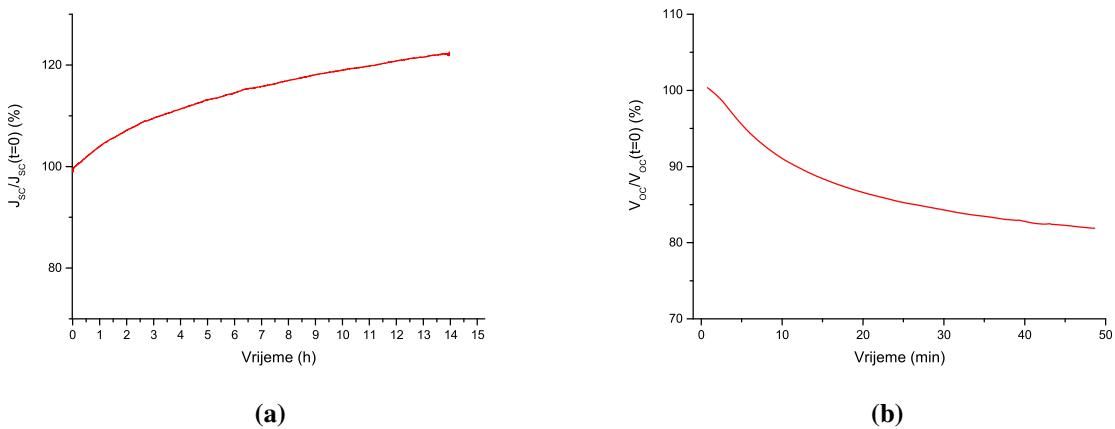
**Slika 7.13:** Mjerenja stabilnosti hibridne fotodiode temeljene na podlozi silicija strukturiranog mikropiramidama tijekom osvjetljenosti laserom valne duljine od 1550 nm i snage od 10 mW - (a) ovisnost struje kratkoga spoja o vremenu i (b) ovisnost napona otvorenog kruga o vremenu.
