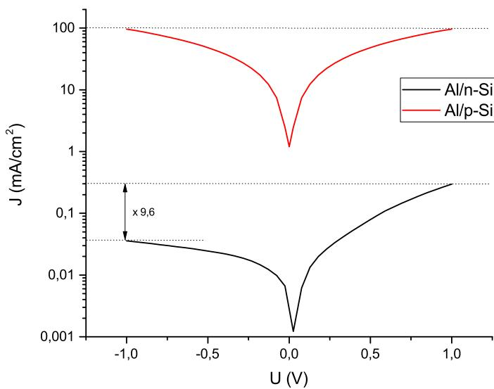
**Slika 4.7:** Usporedba  $J$ - $V$  karakteristika para ohmskih Al/ $p$ -Si i ne-ohmskih Al/ $n$ -Si kontakata. Ohmski kontakt imaju simetričnu  $J$ - $V$  krivulju u logaritamskoj skali, dok se kod ne-ohmskih vidi ispravljački omjer od 9,6 u rasponu od -1V do 1V. Više gustoće struje kod ohmskog spoja znače i manji kontaktni otpor.
