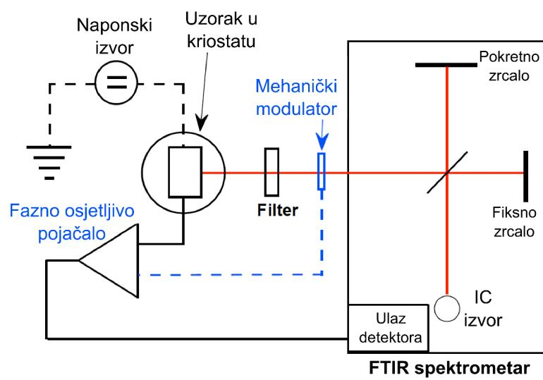
**Slika 5.5:** Postava FTIR spektrometra za mjerene spektralno razlučene fotostruje fotodiode.
