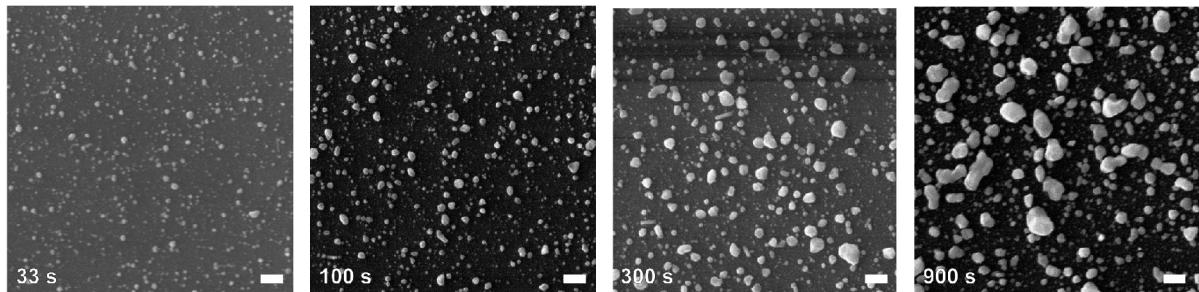
**Slika 4.3:** SEM mikroografi srebrnih čestica nastalih redukcijom na siliciju iz  $\text{AgNO}_3$  u vodenoj otopini amonijeva fluorida, uz različita vremena rasta čestica srebra. Čestice su korištene za pripremu poroznog silicija metalom potpomognutim elektrokemijskim jetkanjem silicija. Veličina skale je  $1 \mu\text{m}$ .
