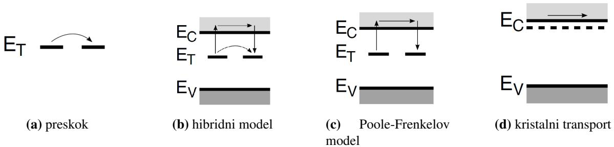
**Slika 3.7:** Modeli transporta u organskim poluvodičima: (a) vodljivost preskokom/perkolacijama sastoji se od preskoka nositelja između lokaliziranih stanja (b) hibridni model (preskok + Poole-Frenkel) (c) Poole-Frenkelov model - vodljivost podizanjem naboja u delokaliziranu vrpcu, gdje se može slobodno gibati dok ne bude ponovno zarobljen (d) model kristalne vodljivosti, gdje do transporta elektrona dolazi u vodljivoj vrpci. Prilagođeno iz [87]
