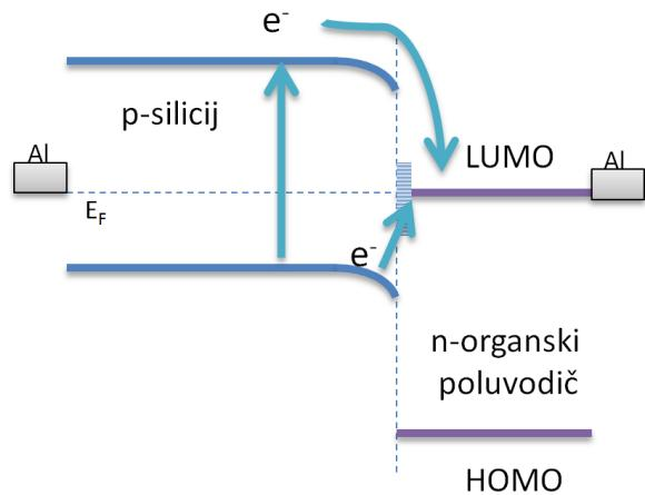
**Slika 6.10:** Predloženi model hibridnog heterospoja *p*-silicija i *n*-organskog poluvodiča, u kojemu su Fermijeva razina i LUMO razina zaključani gustoćom stanja oko polovice energijskog procjepa Silicija.
