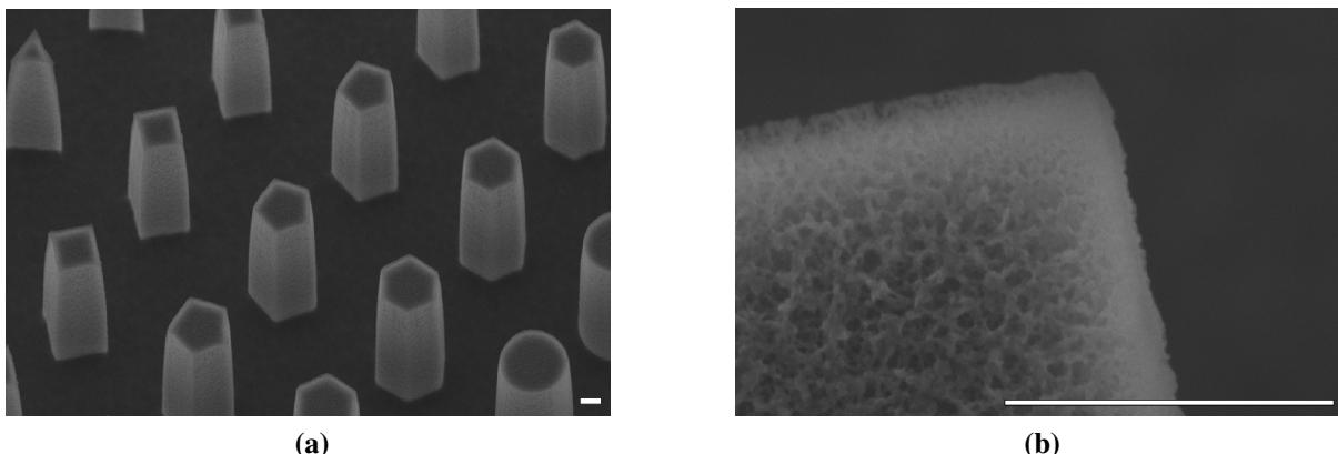
**Slika 2.7:** SEM mikrografi (a) tankog sloja poroznog silicija pripremljenog jetkanjem u otopini fluorovodične kiseline i nitratne kiseline različitih silicijskih struktura pripremljenih reaktivnim ionskim jetkanjem i (b) detalj s vrha jedne od struktura na kojoj se vidi poroznost sloja. Duljina skale je  $1\mu\text{m}$ . Uzorci su pripremljeni u suradnji s LMSC/EPFL Lausanne.
