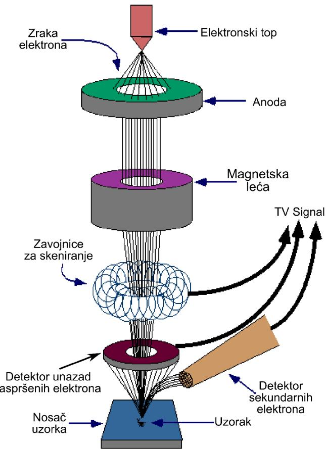
**Slika 5.6:** Shematski prikaz dijelova pretražnog elektronskog mikroskopa.
