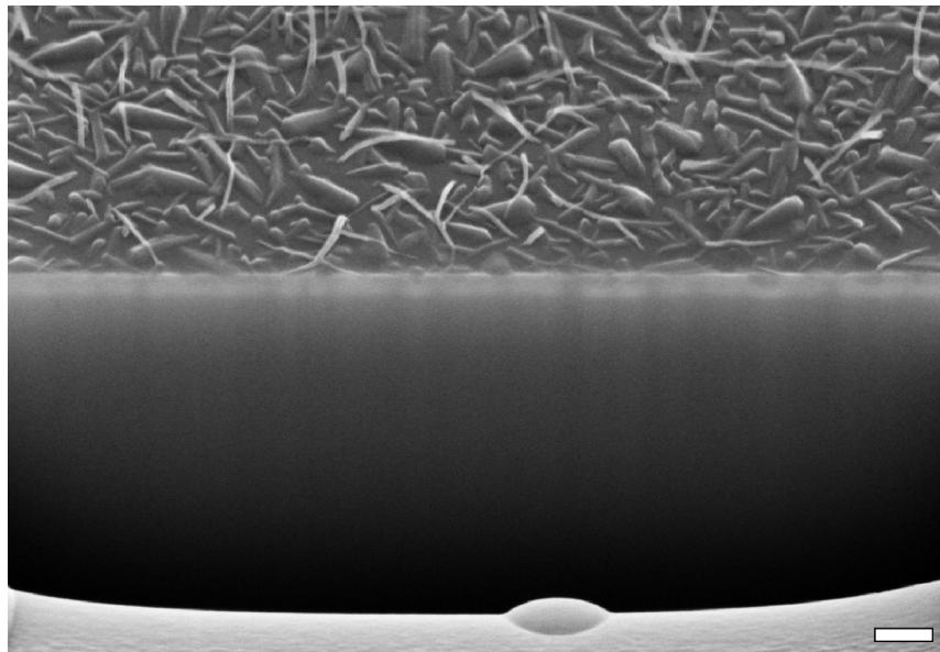
**Slika 7.3:** SEM mikrograf presjeka tankog sloja DiMe-PTCDI nanesenog na površinu silicija HWE metodom. Presjek je dobiven fokusiranim zrakom iona galija . Dimenzije skale su 200 nm. Slika prenesena iz [106].
