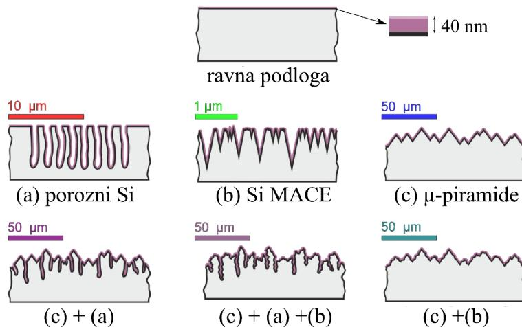
**Slika 7.7:** Shematski prikazi heterospojeva između ravne ili strukturirane podloge silicija i tankog sloja tirskog purpura. Gornji red prikazuje strukturiranje u jednom koraku, dok su u drugom redu prikazane hijerarhijske strukture.
