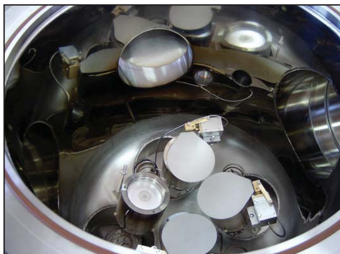
Slika 3: Pogled na četiri magnetronska izvora na dnu komore uređaja CMS-18.
